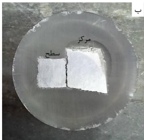
شکل ۳ تصاویر نمونه‌های استخراج شده از سطح و مرکز شمش‌های ریخته شده در (الف) شرکت بلوچ آلومینیوم و (ب) شرکت ایرالکو
