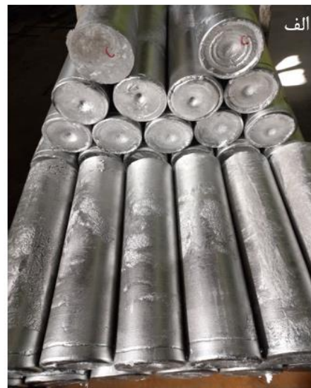
شکل ۱ (الف) نمونه‌ای از بیلت‌های تولیدی توسط فرایند ریخته‌گری در شرکت بلوچ آلومینیوم، (ب) طرحواره نحوه استخراج و ابعاد نمونه آزمون کشش
