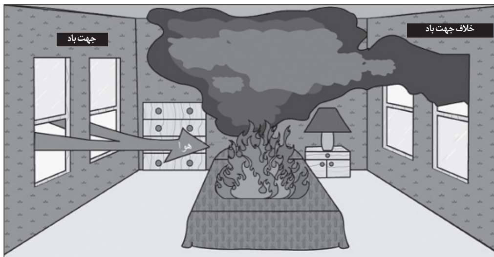
شکل (9): تهویه افقی با کمک باد.
