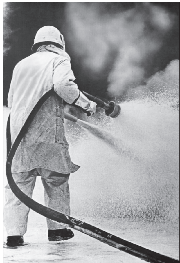
شکل (11): عملکرد سرلوله هوادهی کف.
