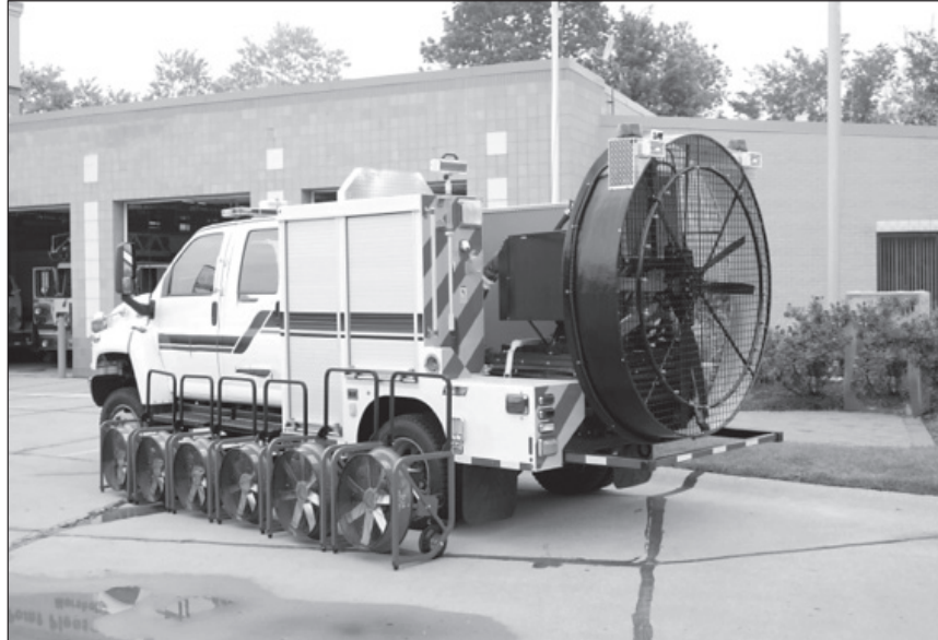
شکل (12): واحد سیار تهویه مجهز به دستگاه‌های دمنده هوا
