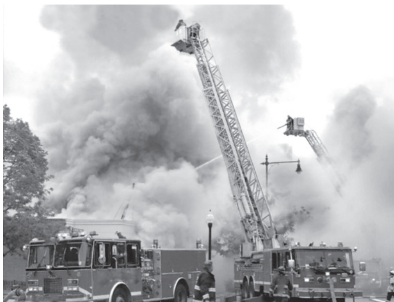
شکل (5): با استفاده از خودروهای مخصوص آتش‌نشانی و کاربرد جریان‌های آب در ارتفاع بالاتر از سطح زمین جهت خنک‌کردن ستون دود، احتمال ایجاد حریق‌های ثانویه ناشی از غبار و دودهای حریق کاهش می‌یابد.
