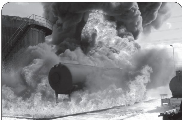
شکل (3): کف کلاس B جهت کنترل حریق مایعات قابل اشتعال ساخته شده است.
