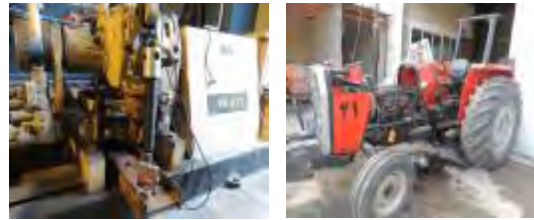
شکل ۱- دینامومتر اصطکاکی - هیدرولیکی (چپ) و تراکتور ITM285 (راست)
