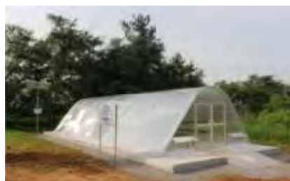
شکل ۱- نمونه‌ای از یک خشک‌کن گلخانه‌ای
