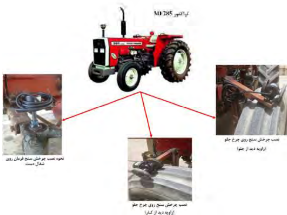
شکل ۳- نحوه نصب چرخش سنج‌ها روی تراکتور MF285
