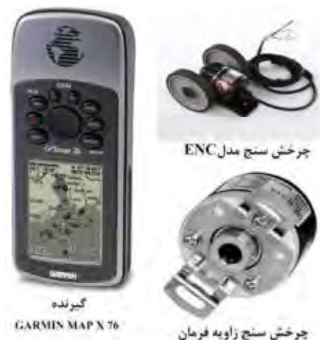
شکل ۲- چرخش سنج‌ها (rotary encoders) و گیرنده GPS
