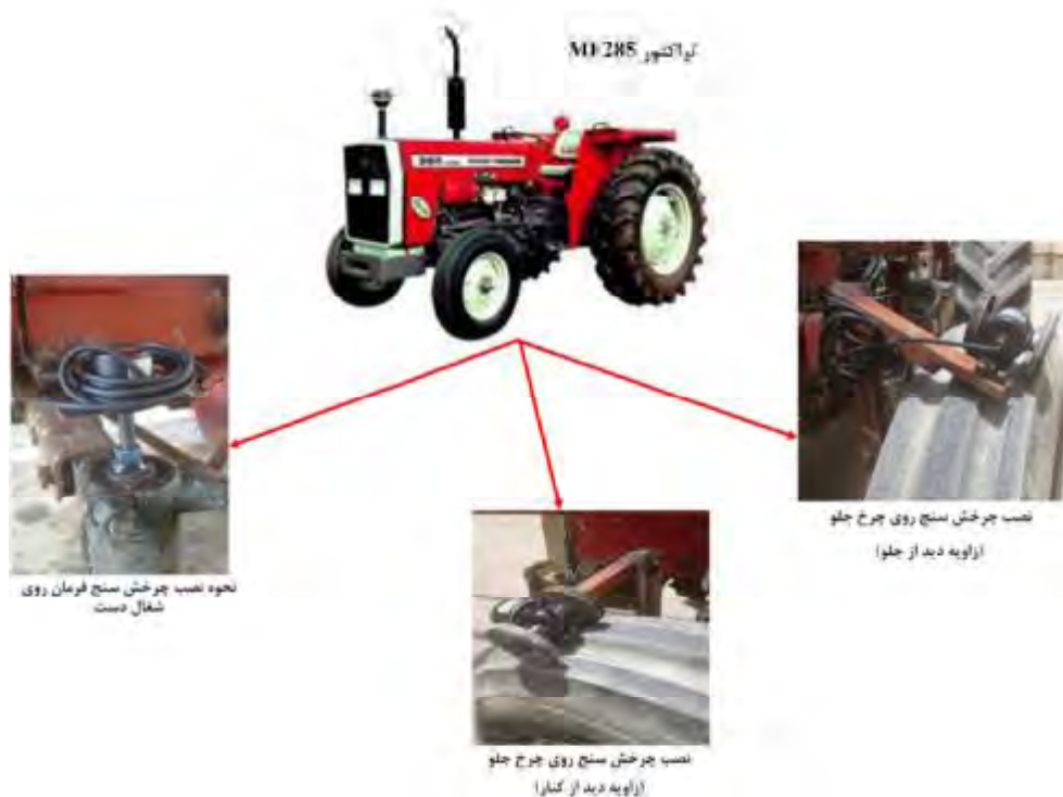
شکل ۳- نحوه نصب چرخش‌سنج‌ها روی تراکتور MF285
