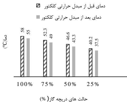
شکل ۴- دمای آب قبل از مبدل حرارتی گردآورنده و بعد از مبدل حرارتی گردآورنده
