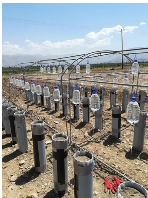
شکل ۱. نمایی از نحوه اجرای آزمایش با استفاده از لوله‌های پلیکا (پی‌وی‌سی)
