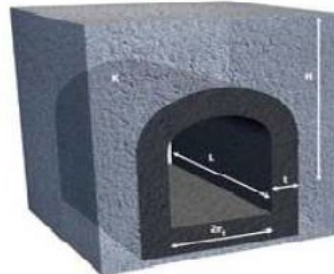
شکل ۲- هندسه محیط تزریق شده و پارامترهای مورد نظر [۶]
