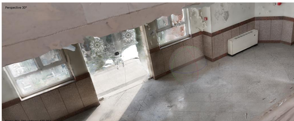
شکل ۸: نتایج حاصل از افزودن بافت تصویر به مدل سه بعدی ساختمان Fig. 8: The results of adding image texture to the building 3D model
