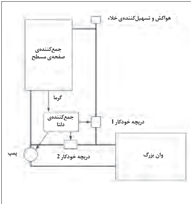
شکل (1): سامانه‌ی گرم‌کننده‌ی وان بزرگ که برای تنظیم دما از کنترل‌کننده‌ی دلتا استفاده می‌کند
