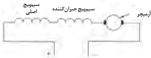
نمونه‌ای از یک موتور یونیورسال تقویت شده
