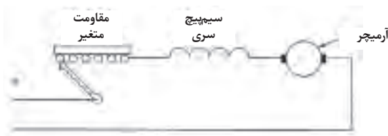
نمونه‌ای از یک موتور یونیورسال که سرعت آن توسط مقاومت متغیری که به صورت سری با موتور قرار گرفته است کنترل می‌شود.
