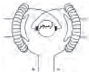
نمونه‌ای از یک موتور یونیورسال که در خلاف جهت چرخش عقربه‌های ساعت کار می‌کند.
