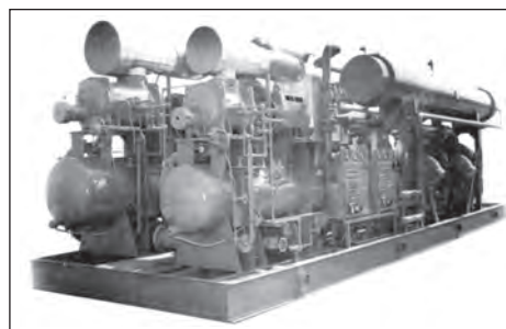
تصویر (9): واحد سردساز یکپارچه دومرحله‌ای برای تقطیر گاز کربنیک در دمای -32°C
