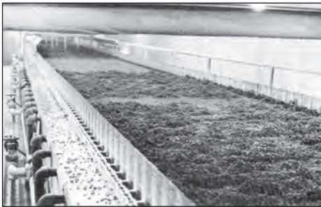
تصویر (5): منجمد کردن نخود فرنگی روی تسمه نقاله‌های با بسترهای شده
