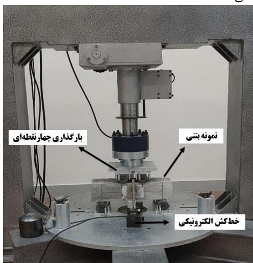
شکل (۲). پیکربندی آزمایش مقاومت پسماند بتن الیافی
