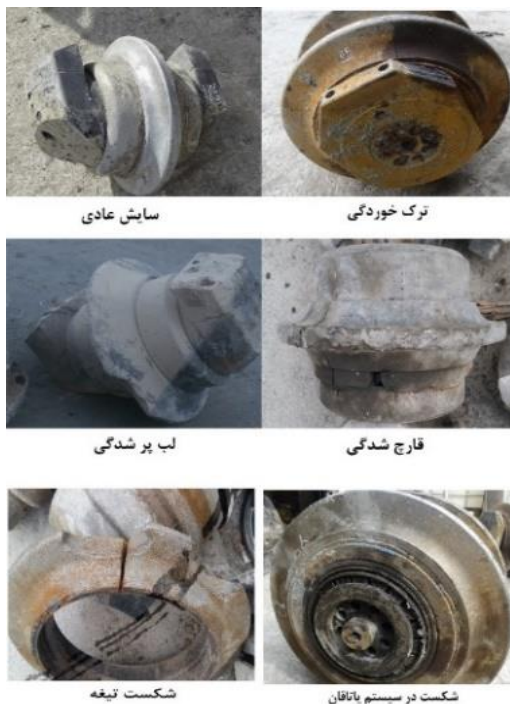
شکل (۳). نمونه‌ای از الگوهای متداول خرابی تیغه‌ها در قطعه ۲ تونل کانی سیب
