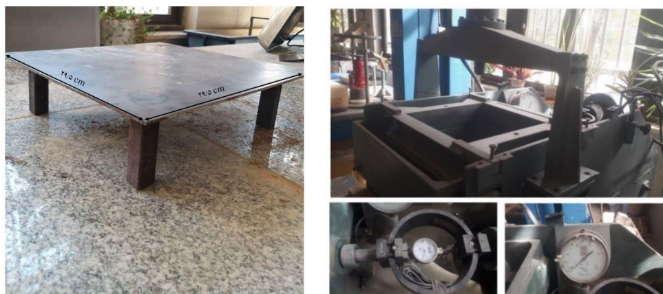
شکل ۸ دستگاه برش مستقیم اصلاح شده بزرگ مقیاس مورد استفاده و نمونه قالب ساخته شده
