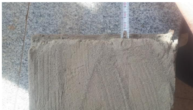
شکل ۱۱ نمونه برش مستقیم بزرگ مقیاس
