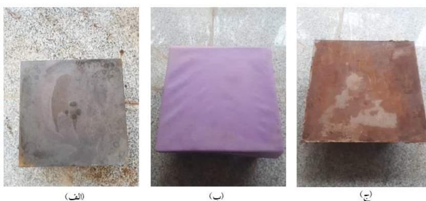
شکل ۹ قالب‌های برش مستقیم اصلاح شده بزرگ مقیاس: (الف) سطح صیقلی، (ب) سطح پوشیده شده با ژئوتکستایل، (ج) سطح زیر
