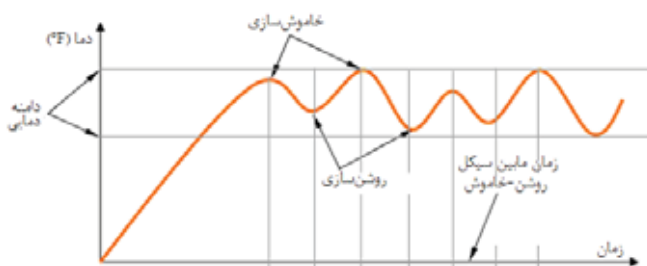
شکل ۳: نمودار دما-زمان برای کنترل حلقه باز اجاق
