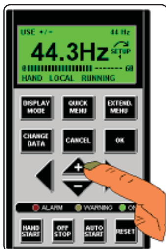
شکل ۴: VFD باید قادر به تغییر مرجع (Hz) باشد. به‌علاوه «مرجع» در شرایط اتصال یک فرارسان (ترنس‌میتتر) به VFD می‌تواند از نوع PSI نیز باشد.
